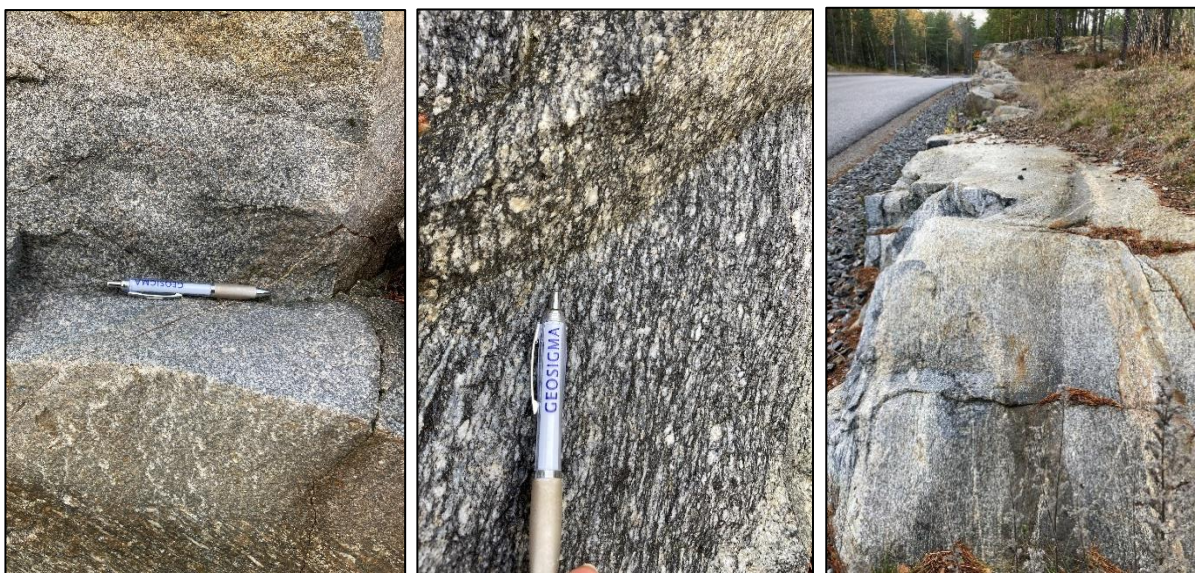
Figur 6-3. Observerad bergart i område E, ljus grå, medelkornig granit med massiv struktur (t.v.), mörkt grå medel- till grovkornig granit med gnejsig struktur (mitten) samt en blandning av granit och gnejs med inslag av finkorniga glimmerrika delar (t.h.).
